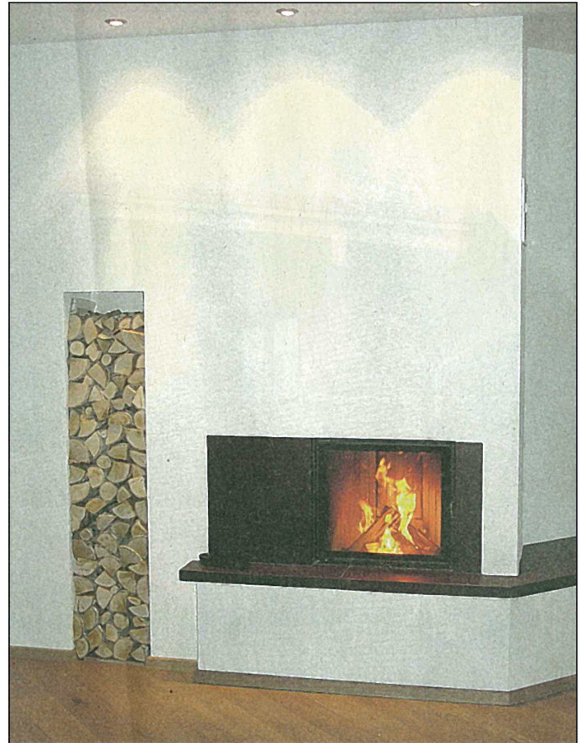
Die Glastüren strahlen Wärme unmittelbar ab, während die keramische Speichermasse nur langsam Wärme aufnimmt und diese dann gemächlich wieder abgibt. (Foto: Keramik Decker, Straubing)
